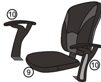
11. Сиденье установите отверстием в металлической площадке на газпатрон.
