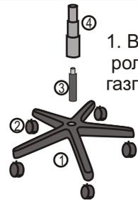
1. В пятилучье ① установите: ролики ②, газпатрон ③ и кожух ④
