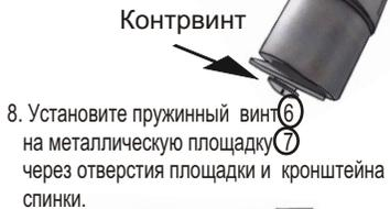
8. Установите пружинный винт ⑥ на металлическую площадку ⑦ через отверстия площадки и кронштейна спинки.
