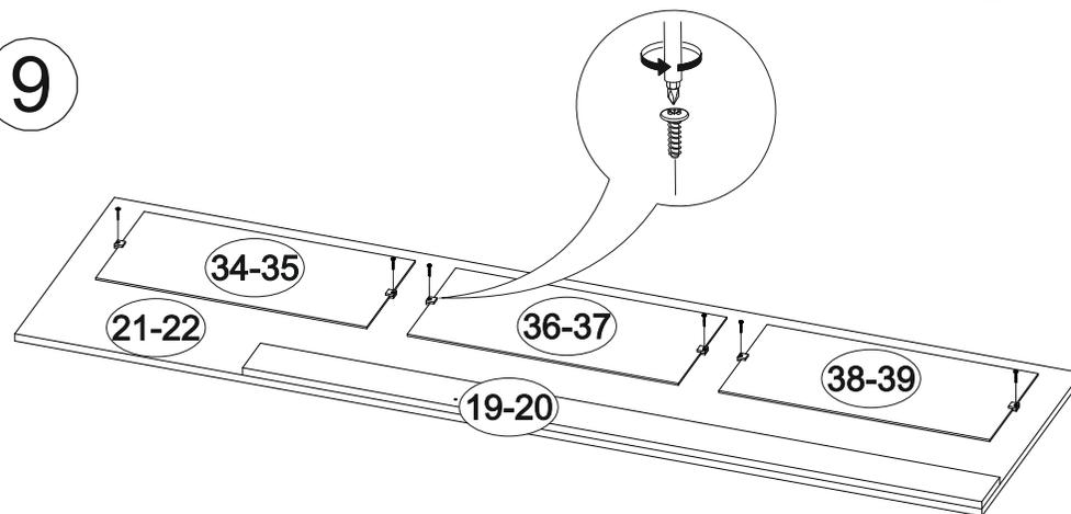
**Внимание!** Монтаж зеркал/стекел к фасадам производится самостоятельно на двусторонний скотч и/или кляймеры **ОБЯЗАТЕЛЬНО** для крепления необходимо использовать монтажный клей «жидкие гвозди»
