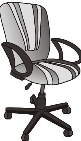
1. В пятилучье ① установите ролики ②, поставьте нижнюю втулку ④, газпатрон ③ и кожух ⑤
