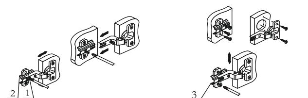
Регулировка створки по ширине   Регулировка створки по высоте
