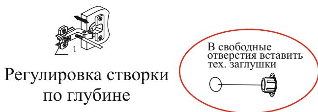
Регулировка створки по глубине
